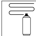
Appliquer en fines couches immédiatement après l'application du vernis 2K ou de la peinture de finition 2K sur la zone de transition de façon à obtenir une surface homogène.
